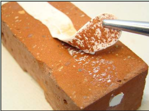
Porøs overflate = Ingen heft!
